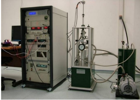
Şekil 2. Elektriksel ve manyetik özellikler ölçme düzeneği
