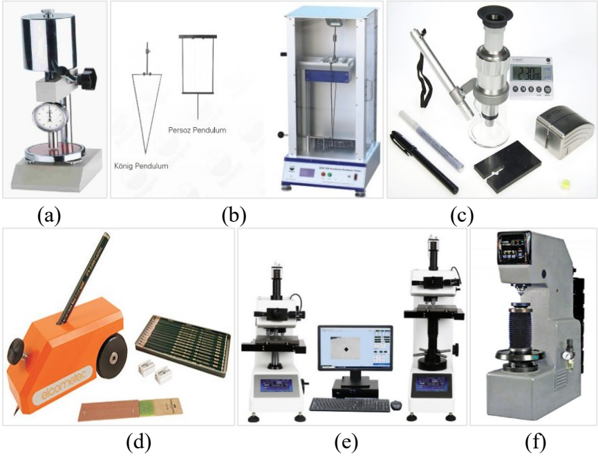
Şekil 1. (a) Shore D test cihazı (Yamer, 2024), (b) Pandüllü (Pendulum) sertlik test cihazı (Tpmequipos, 2024), (c) Buchholz sertlik test cihazı (Industrialphysics, 2024), (d) Kalem sertlik testi cihazı (Elcometer, 2024), (e) Knoop ve Vickers mikrosertlik test cihazı (Sinowon, 2024), (f) Brinell sertlik test cihazı (Hardnesstesters, 2024).
