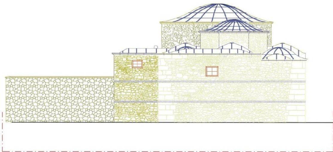
Şekil 6. Başçavuş Hamamı Batı Cephesi (Rölöve yazara aittir.)
