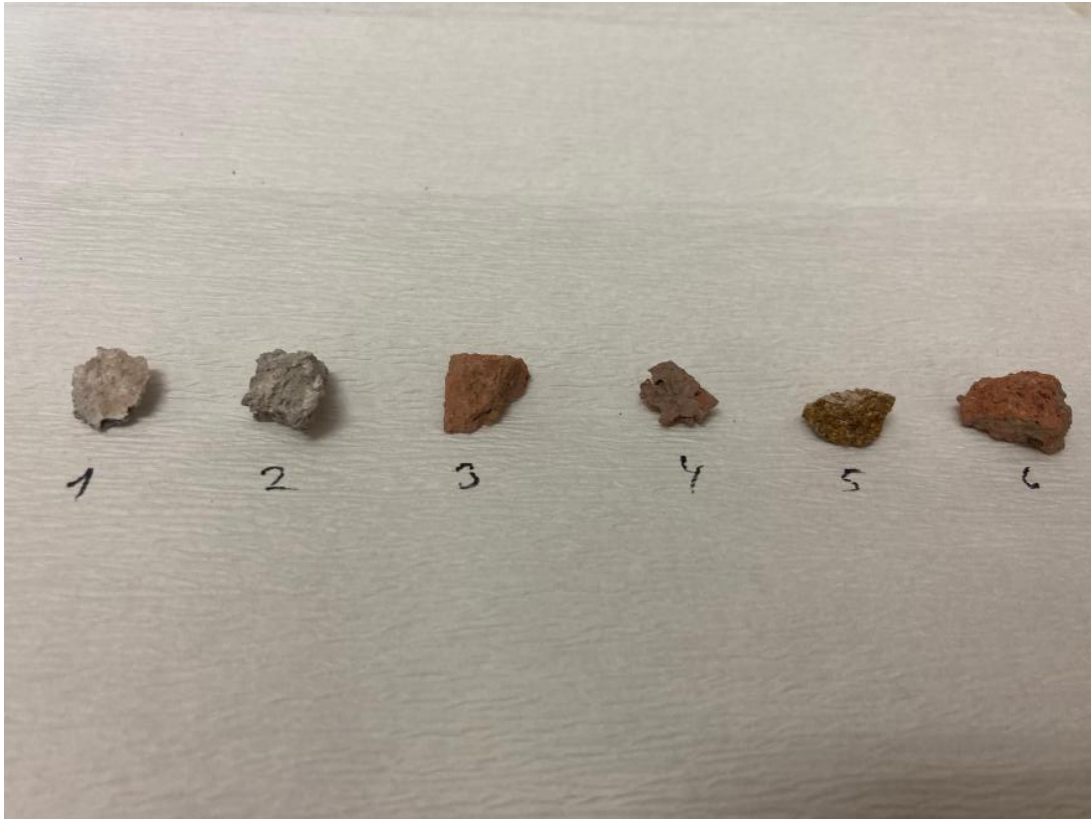
Şekil 15. Başçavuş Hamamı'ndan temin edilen ve mikroyapısal inceleme amacıyla hazırlanan 1–6 no'lu yapı malzemesi numuneleri. Numuneler; harç, tuğla ve taş gibi farklı yapı bileşenlerini temsil etmektedir.
