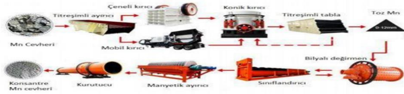
Şekil 8. Cevher zenginleştirme aşamaları basitleştirilmiş akış şeması ( https://www.jxscmachine.com/new/manganese-ore-beneficiation/-2021 ).
