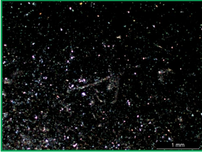
Şekil 17. Çaltepe formasyonu yumrulu kireçtaşlarındaki kirli, fosilli-pelletli mikritik kireçtaşı (çamurtaşı-vaketaşı), opak mineral, kuvars (Örnek: G90; Çift Nikol).
