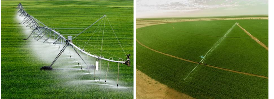
Şekil 8. Merkezden dönen sulama yöntemi
