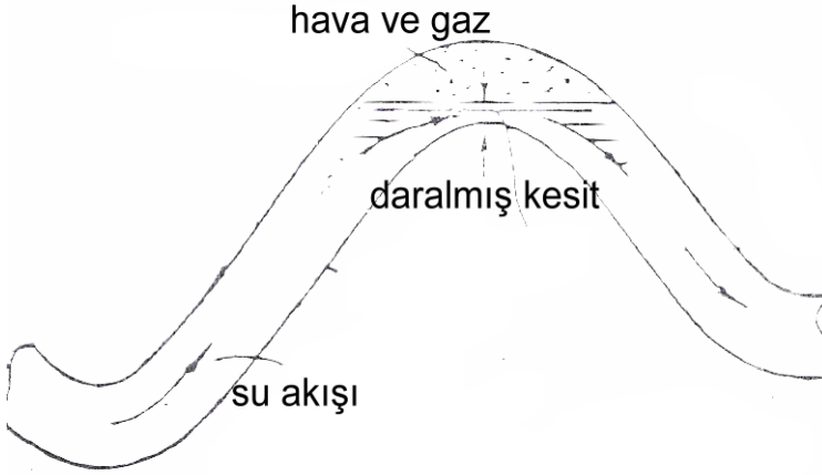
Şekil 2.9. Hava ve gaz birikmesi ile kesiti daralan bir tepe noktası
