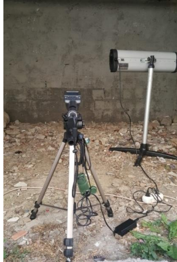
Resim 3 Örnek uygulama için hazırlanan aktif termografi düzeneği
