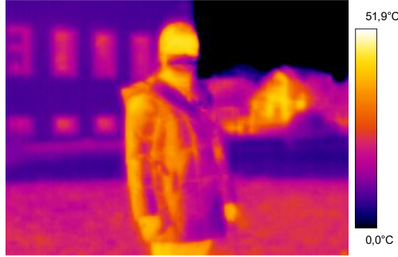
Resim 1 Pasif termografi ile doğal ortamda bir insanın vücut ısısı ve çevredeki cisimlerin ısı görüntüsü
