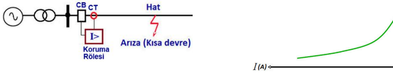
Şekil 14. Radyal şebekede ters zamanlı aşırı akım rölelerinin koordinasyonu
