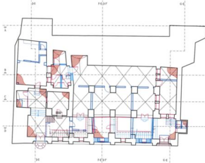
Şekil 6. Restorasyon Projesi (Zemin ve 1. Kat Planı, 2010)
