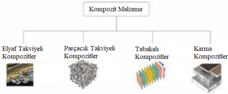
Şekil 2. Kompozit malzemenin takviye ediciye göre sınıflandırılması
