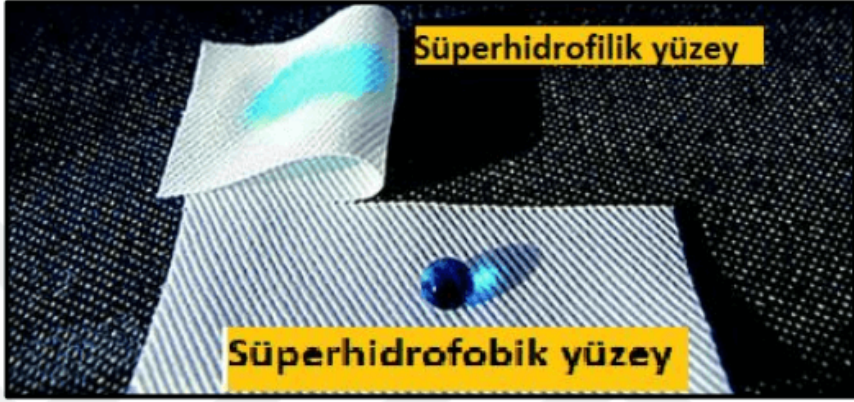
Şekil 2: Süperhidrofobik Yüzey ve Süperhidrofilik Yüzey
