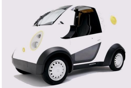
Resim 13 Honda Firması Tarafından 3D Yazıcı İle Üretilmiş Elektrikli Araç
