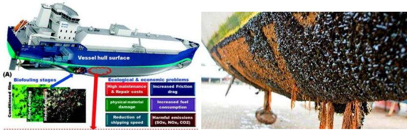
Şekil 2: Biyolojik kirlenme aşamaları ve kirli gemi yüzeyi
