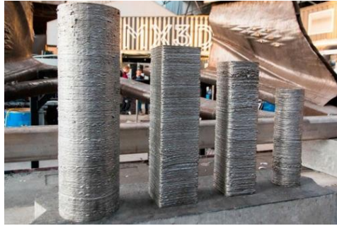
Resim 8 3D Yazıcı Teknolojisiyle Üretilmiş Metal Numuneler
