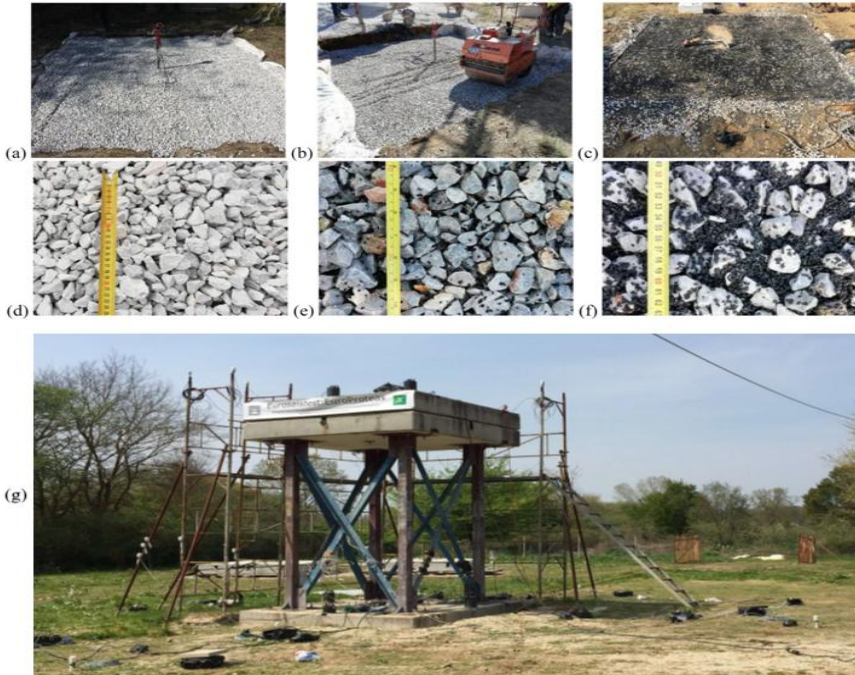
Şekil 15 Zemin çukuru ve dolgu içerikleri a) GRM100/0, b) GRM90/10, c) GRM70/30, d) GRM100/0, e) GRM90/10, f) GRM70/30, g) deney düzeneği genel görünüşü
