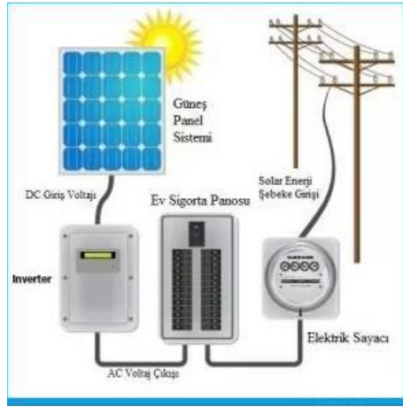
Şekil 1. Fotovoltaik panellerin dağıtım şebeke entegrasyon modeli [8]
