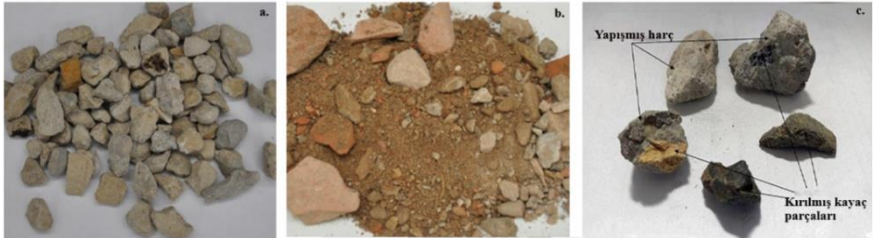
Şekil 2. GDB agregası görüntüsü (a. Yol yapımında GDB agregası b. Bina yıkımında GDB agregası c. GDB agregaya yüzeyine yapışmış harç ve kırılmış kayaç parçaları)
