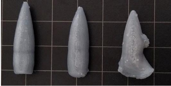
Resim 3: 3D Yazıcılar ile Yazdırılan ve Karşılaştırma İşlemlerinde Kullanılan Ateşlenmemiş, Ateşlenmiş ve Deforme Olmuş Mermiler
