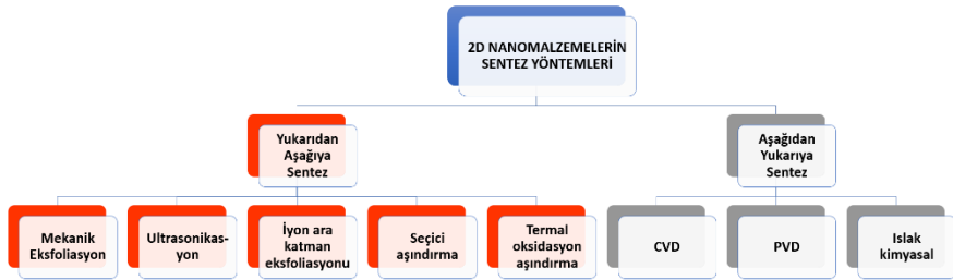
Şekil 1. 2D nanomalzemelerin temel sentez yöntemleri. Aşağıdan yukarıya sentez: CVD, PVD ve ıslak kimyasal. Yukarıdan aşağıya sentez: mekanik ayırma, ultrasonikasyon, iyon ara katman eksfoliasyonu, seçici aşındırma ve termal oksidasyon aşındırma
