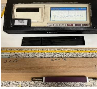
Resim 3-Freze ölçüm cihazı ile freze değeri tayini
