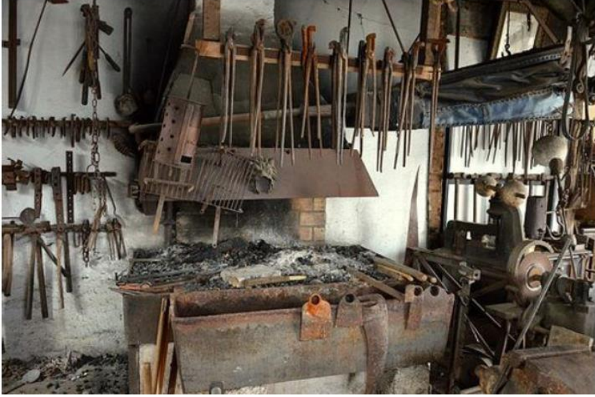
Şekil 1. Dövme demirin işlendiği demirci ocağı
