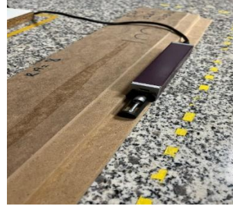
Resim 4-Freze ölçüm cihazı ile freze değeri tayini
