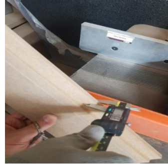
Resim 2 Numunelere freze kanalı açılması
