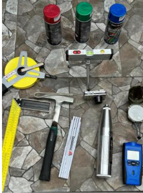
Şekil 1. Geleneksel süreksizlik ölçüm ekipmanları (Madear vd., 2023)
