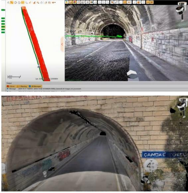
Şekil 4. El tipi LiDAR cihazı ile elde edilen nokta bulutu ve 3B tasarım (Koyuncu Teknik Cihazlar, 2025)
