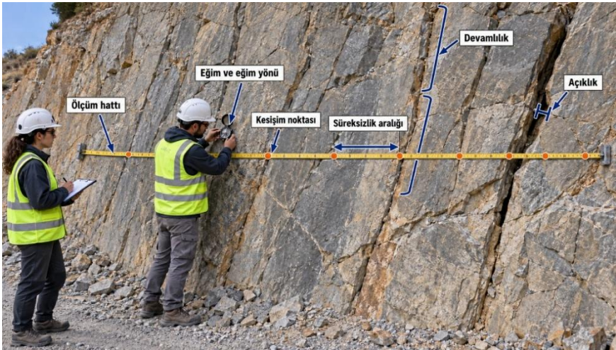
Şekil 2. Şev aynasında yapılan hat etüdü
