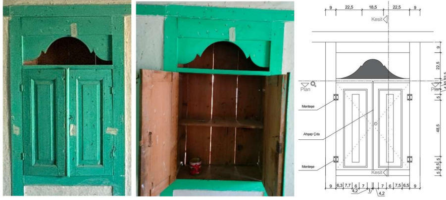
Şekil 18. Dolap 4 görseli ve rölöve çizimi
