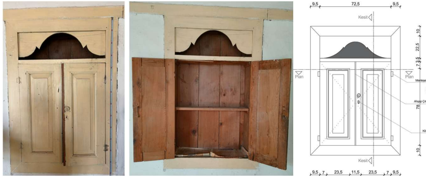
Şekil 19. Dolap 5 görseli ve rölöve çizimi
