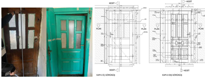
Şekil 23. K3 Kapı iç ve dış görselleri ve rölöve çizimleri
