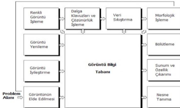
Şekil 5. Görüntü işlemede temel adımlar
