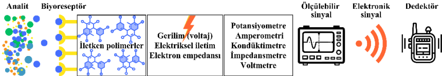
Şekil 1. Biyosensörlerin çalışma mekanizması
