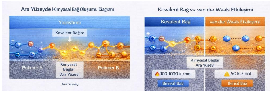
Şekil 9. Ara yüzeyde fiziksel ve kimyasal bağ oluşumu
