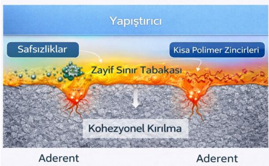
Şekil 6. Zayıf sınır tabakası diyagramı
