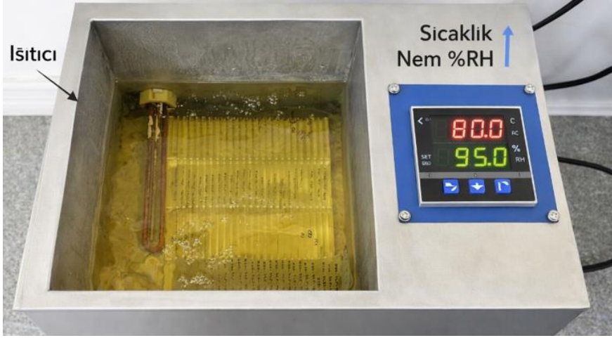
Şekil 17. Yapıştırma bağlantılarında yaşlandırma testi
