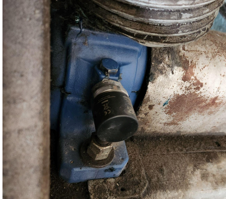
řekil 1 Able Sens 3-eksenli ivme sensörü
