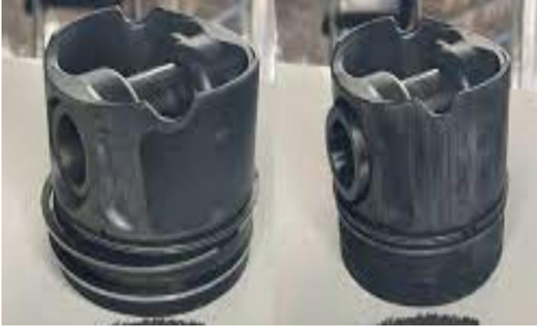
Şekil 4: Pistonlarda oluşan aşınmalar
