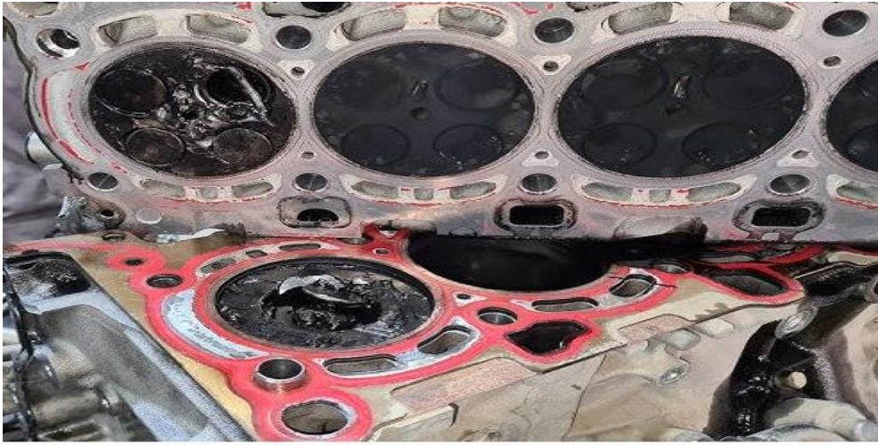
Şekil 3: Yanma sonucu oluşan motor içi kurum
