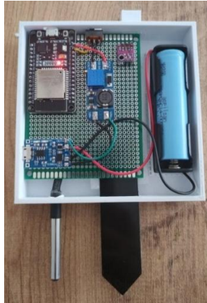
Şekil 3 ESP32 tabanlı IoT sisteminin kutu içi yerleşimi
