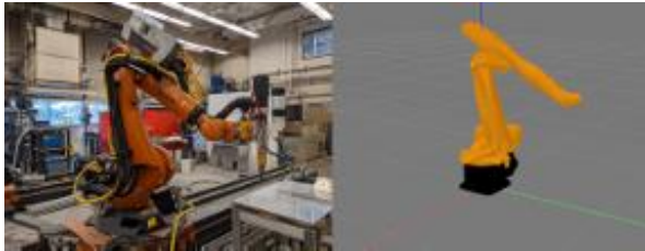
Şekil 5 Fiziksel Robot Kol (solda) ve Dijital ikizi (sağda).
