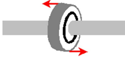
Şekil 29. Hızası bozulmuş rulman
