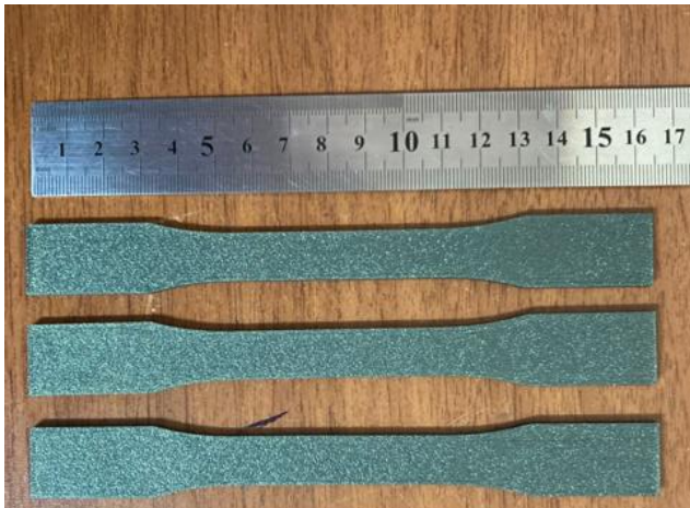
Şekil 3 Üç boyutlu yazıcı ile üretilen çekme numuneleri (PLA)
