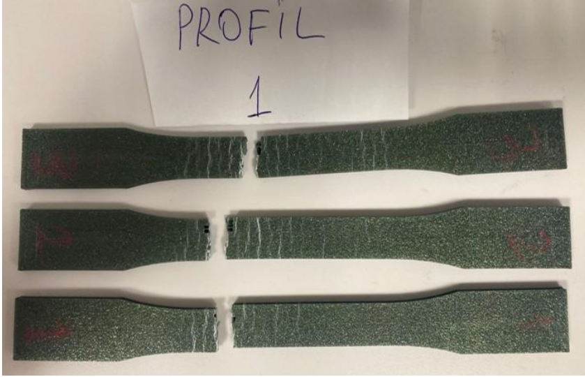
Şekil 4 Üç boyutlu yazıcı ile üretilen çekilmiş numuneler (PLA)
