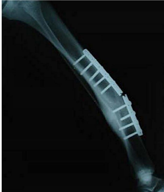
Şekil 5. Bir insan vücudu içindeki hasar görmüş paslanmaz elik implantın radyografik görüntüsü.
