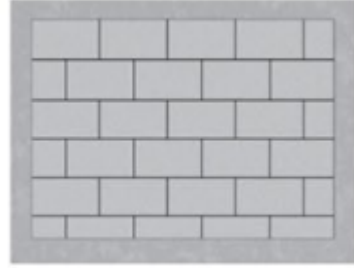
b) Gaz beton duvar
