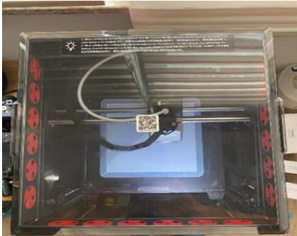
Şekil 5 Prototip istinat tabanı pürüzlerinin 3D yazıcıda basım işlemi
