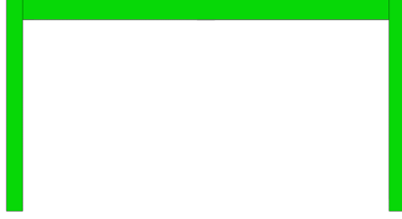
Şekil 1. Çaprazsız tek katlı–tek açıklıklı portal çerçeve Abaqus modeli (HEB240 kolon, IPE300 kiriş).
