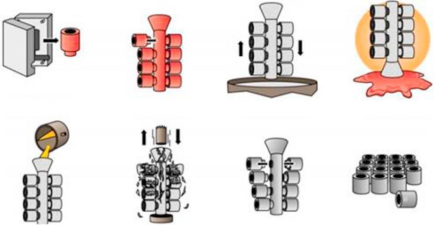
Şekil 1 Mum Modelaj, Seramik Kaplama, Otoklav, Döküm ve Parçaları Ayırma Süreci
