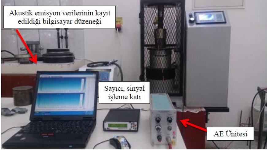
Şekil 3. AE deney düzeneğinin genel görünümü
