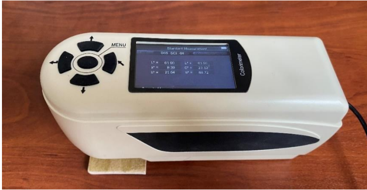
Şekil 8. CIE Lab* Ölçüm Cihazı
