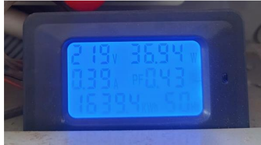
Şekil 4. Wattmetre (Hidance P06S-100)
