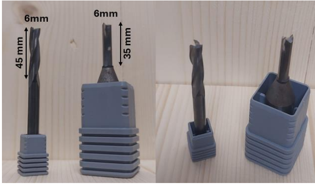
Şekil 2. (a) çift kanallı düz freze ve (b) spiral frezenin kesici uçları
