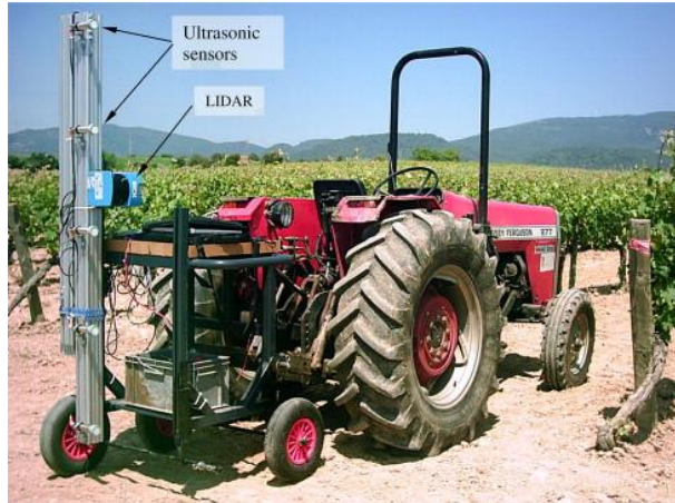
Resim 2. Ultrasonik ve LIDAR sensorn tartkr zerinde kullanımı
