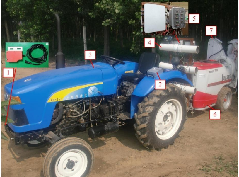
Resim 1. Bahçe tipi ultrasonik sensör tabanlı pülverizatör: fotoelektrik sensör (1), fotoelektrik tabanlı hedefe yönelik kontrol birimi (2), traktör (3), ultrasonik sensör (4), ultrasonik tabanlı hedefe yönelik kontrol birimi (5), depo (6) ve püskürtme ünitesi (7)
