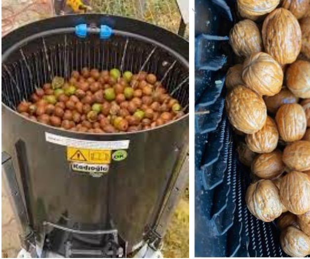
Resim 4 Abrasif (sürtünmeli) kabuk soyucunun ceviz meyvesinde kullanımına ait görünüm
