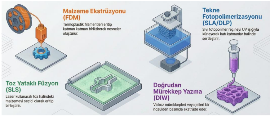
Şekil 3. Yaygın olarak kullanılan katmanlı üretim teknolojileri
