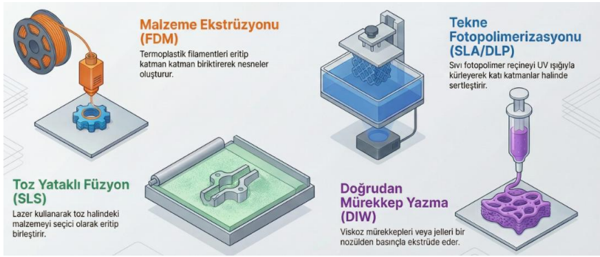
Şekil 3. Yaygın olarak kullanılan katmanlı üretim teknolojileri
