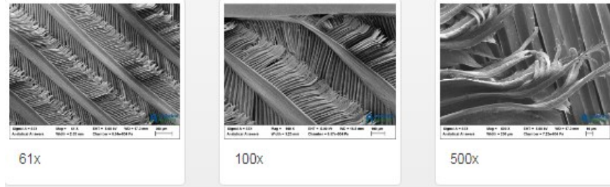
Şekil 4: Hindi tüylerinin taramalı elektron mikroskobunda farklı büyütme oranlarında alınmış görüntüleri
