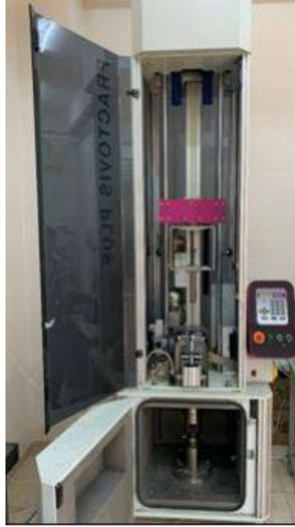
Şekil 7. CEAST Fracovis Plus darbe dayanımı test cihazı
