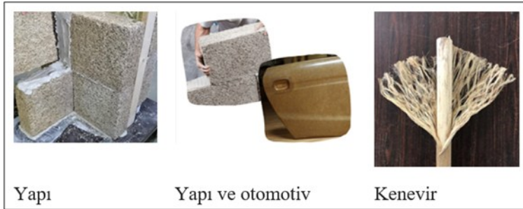
Şekil 12. Kenevir kompozitlerin yapı, otomotiv parçası örnekleri
