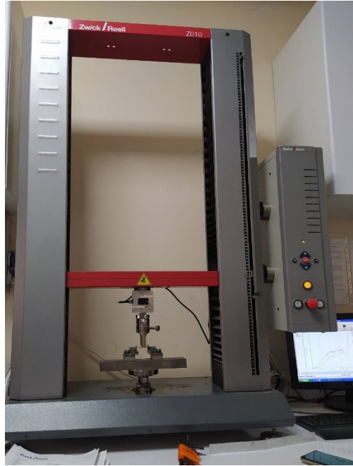
Şekil 4. Zwick Roell Z010 Çekme test cihazı
