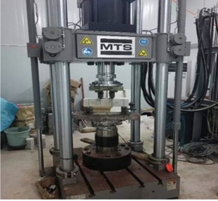
Şekil 8. MTS Landmark yorulma test cihazı
