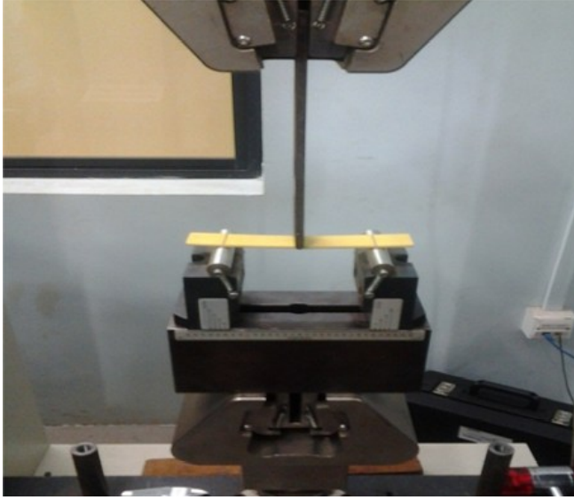
Şekil 6. MTS Insight universal eğilme test cihazı
