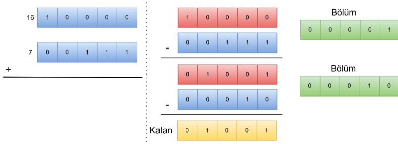
Şekil 6. En büyük ortak bölen algoritması ile 5 bitlik bölme işlemi
