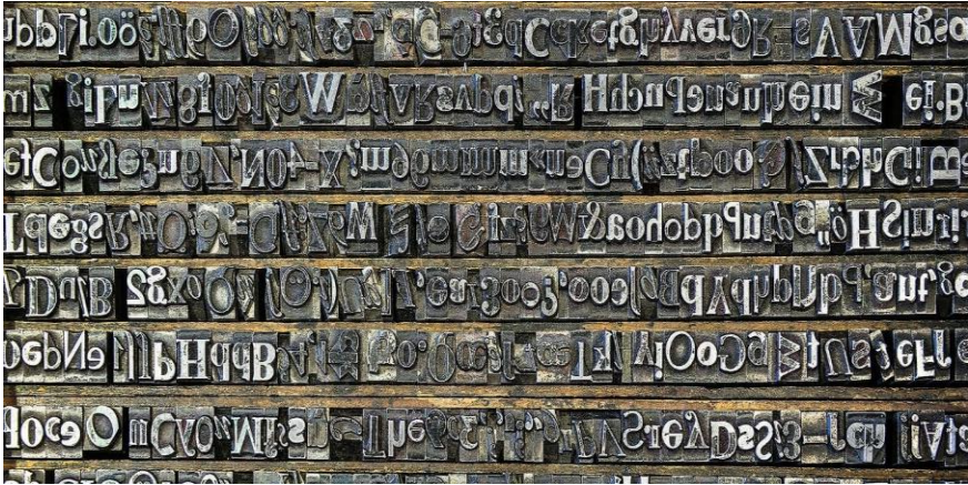
Resim 22. Hareketli hurufat sistemi metal harf blokları.
