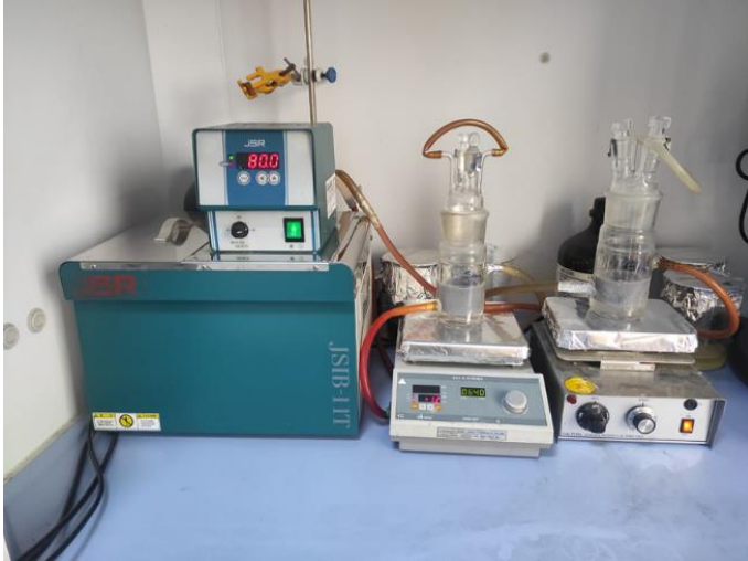
Şekil 5. Süspansiyon polimerizasyon yöntemi kullanılarak polimer partiküllerinin sentezi
