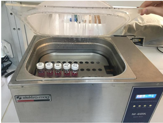
Şekil 12. 45 °C’de adsorpsiyona bırakılan çözeltiler
