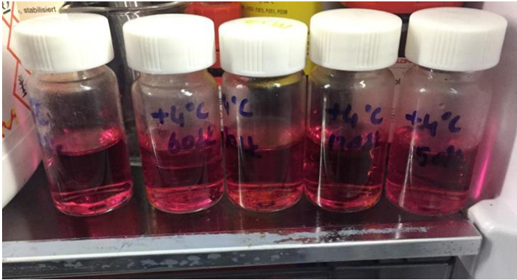
Şekil 10. 4 °C'de adsorpsiyona bırakılan çözeltiler
