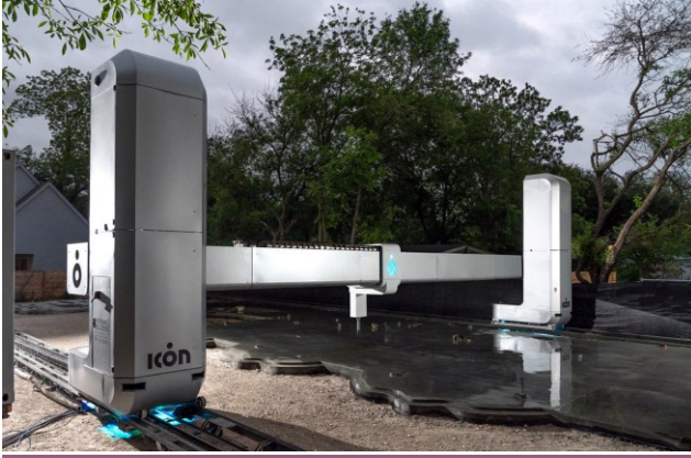
Şekil 5. Vulcan II 3D yazıcı (Web,2)
