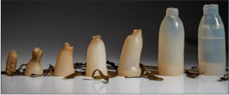
Şekil 10. Kenevir plastiğinin 6 aylık hızlı dökümü (URL 7)
