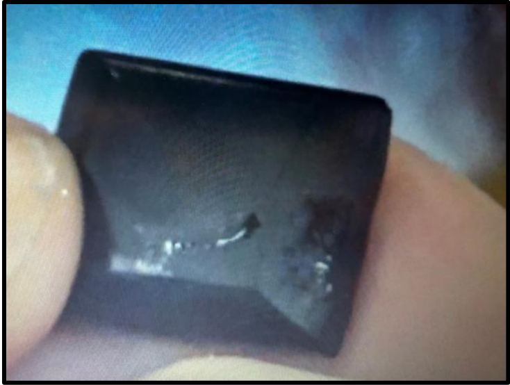
Şekil 12: Zımpara aşaması biten pürüzsüz obsidyen
