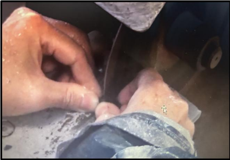
Şekil 5: Süstaşı Obsidyenin Dilim Kesimi
