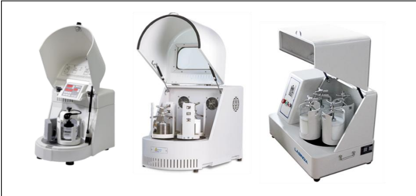
Şekil 1: Tek hazneli ve birden çok (iki ve dört) hazneli gezegensel değirmen tipleri
