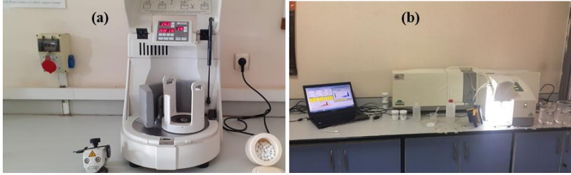
Şekil 4: Öğütme işleminin gerçekleştirildiği gezegensel bilyalı değirmen ve öğütücü ortam bilyaları (a), tane boyutu analizinde kullanılan Mastersizer 2000 tane boyutu analiz cihazı (b).
