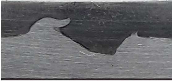
Şekil 3: SKBK kaynaklarının makro kesit alanı fotoğrafları. a) 37 mm/dakika, b) 51 mm/dakika ilerleme hızı
