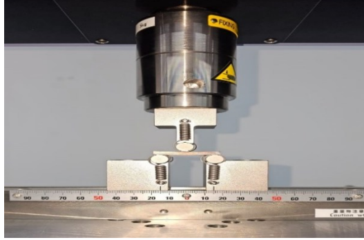
Şekil 5: Üç nokta eğme test cihazı
