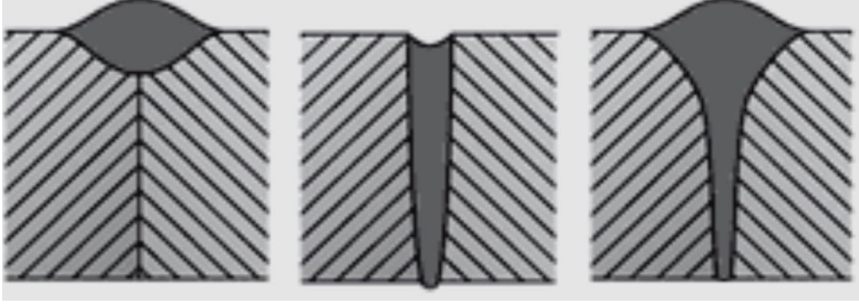
Şekil 21: (a) Ark, (b) Lazer (c) Hibrid lazer ark kaynak yöntemlerinde kaynak ara yüzeylerinin şematik görüntüsü
