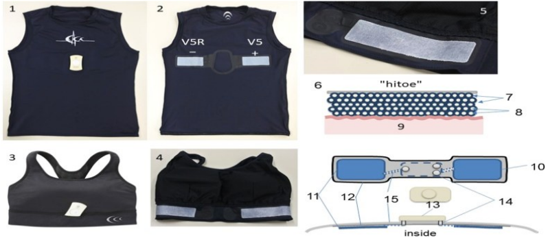
Şekil 1: EKG takibi yapılabilen nanofiber spor yeleği
